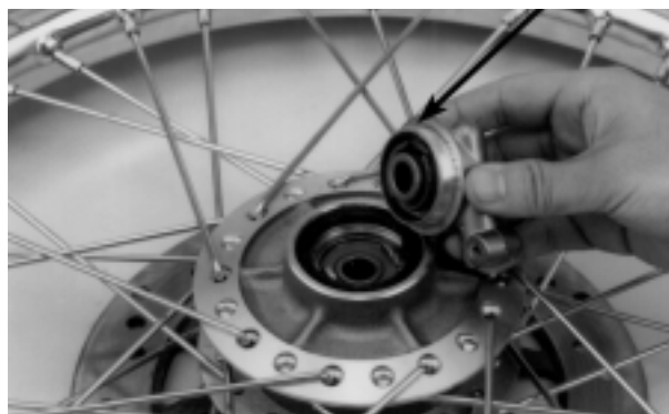
CAIXA DA ENGENAGEM
