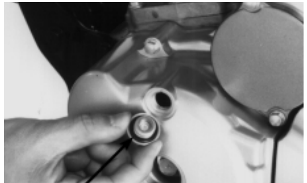
TAMPA DO ORIFÍCIO DE SINCRONIZAÇÃO LUZ ESTROBOSCÓPICA
